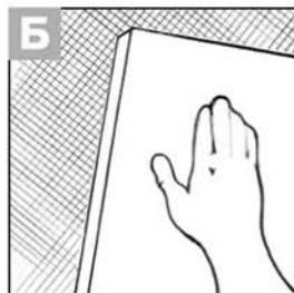
Прижмите строительную плиту THERMIT SP к стене и выровняйте по горизонтали и вертикали.
